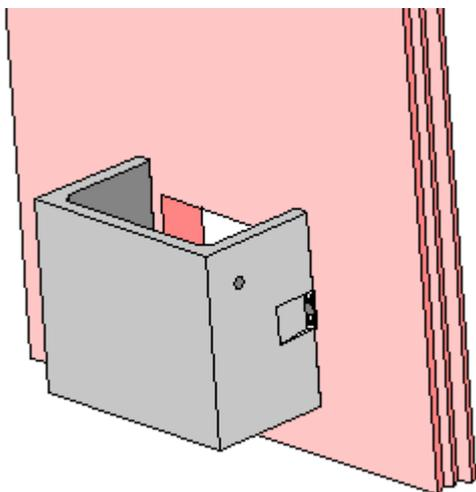
POSA DELLA GRIGLIA (O VETROCEMENTO) CON TELAIO ZANCATO
