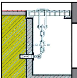
E' un accessorio fornibile su richiesta. Applicato a qualsiasi tipo di griglia, impedisce l'accesso all'apertura sottostante ed il furto della griglia stessa. Nel caso specifico delle Bocche da Lupo, è consigliabile il montaggio di almeno 2 ancoraggi antifurto per griglia. I componenti soggetti a maggior usura sono in acciaio inox AISI 304.
